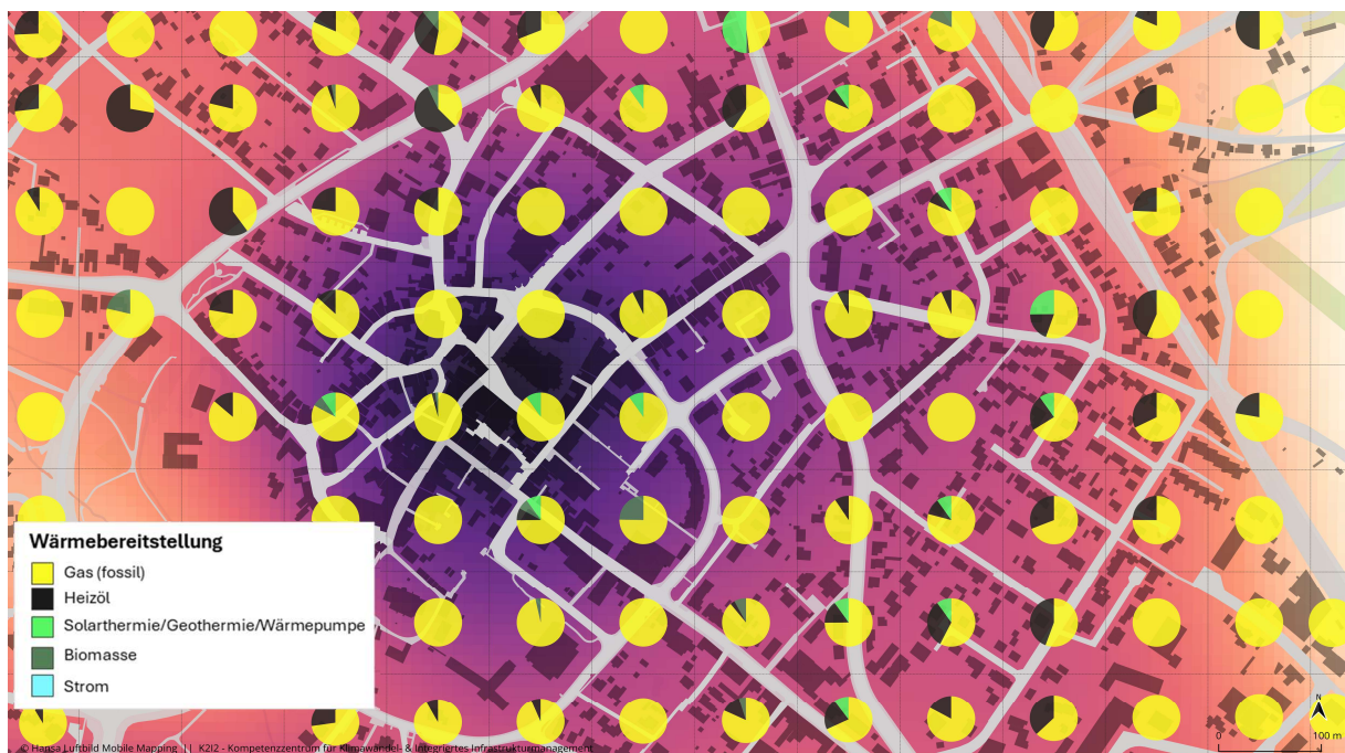
Abb. 10: Ermittelte räumliche Wärmeversorgungsstruktur, dargestellt auf dem 100x100-Meter-Zensusgitter
